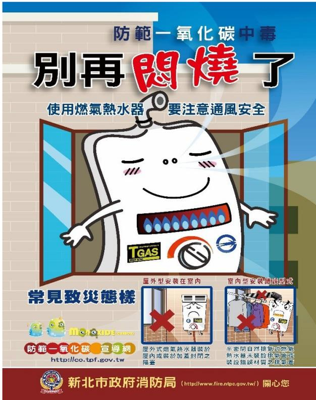
圖 4 瓦斯熱水器要裝在通風處
